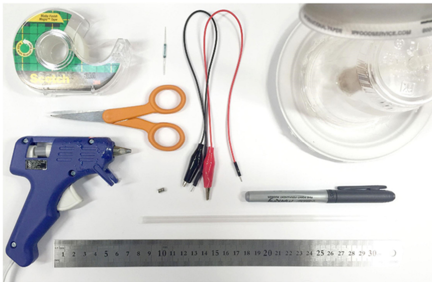
Σχήμα 7 – Υλικά κατασκευής ανεμομέτρου με αισθητήρα (ανακτήθηκε από: https://www.microsoft.com/en-us/education/education-workshop/anemometer.aspx )
